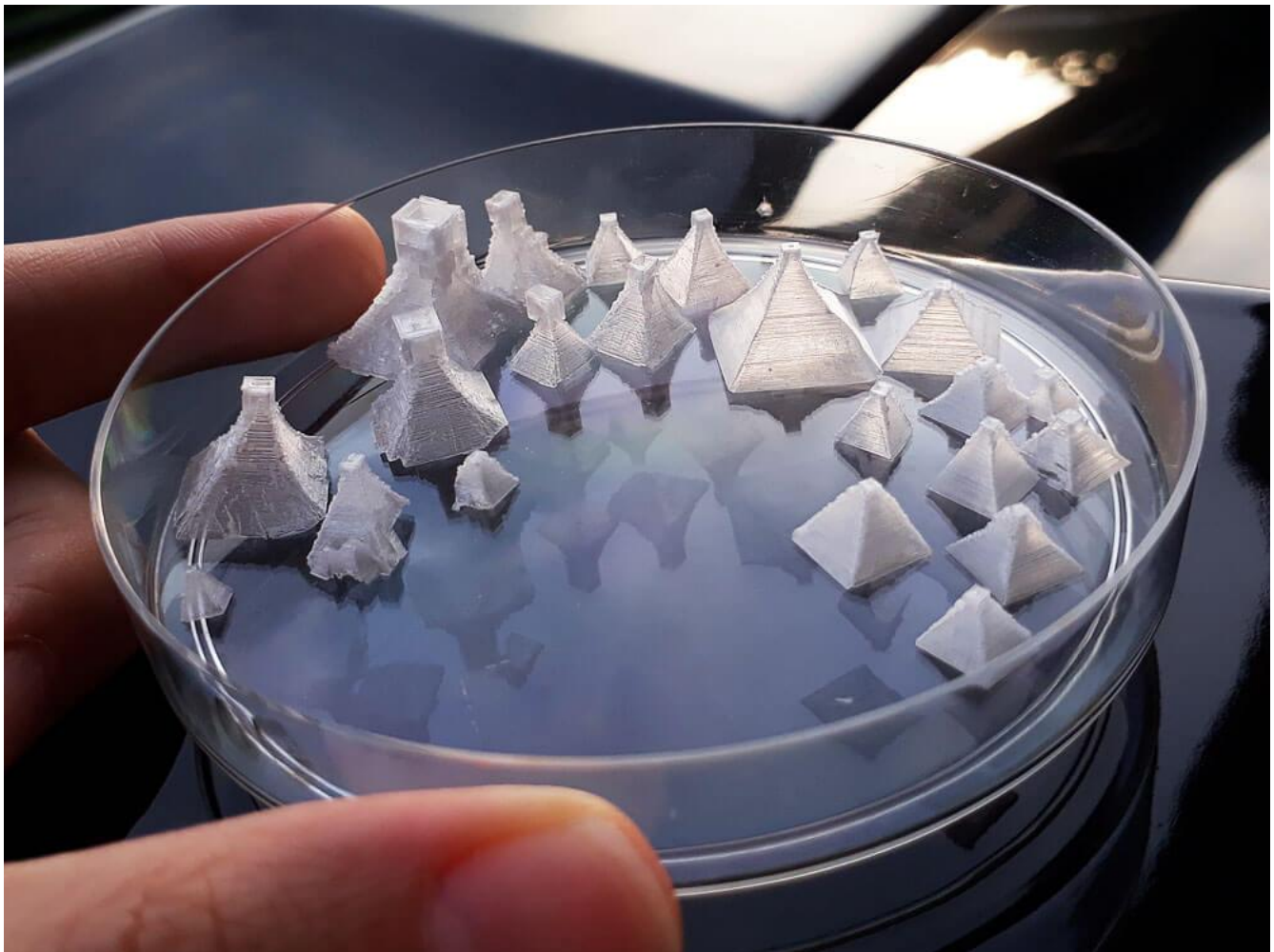
Figure 1. Exemple de tutoriels incroyables disponibles sur Crystalverse par Chase Lean. Ces cristaux de chlorure de sodium (sel de table, NaCl) sont cultivés selon une procédure spécifique permettant d'isoler ces cristaux pyramidaux.
